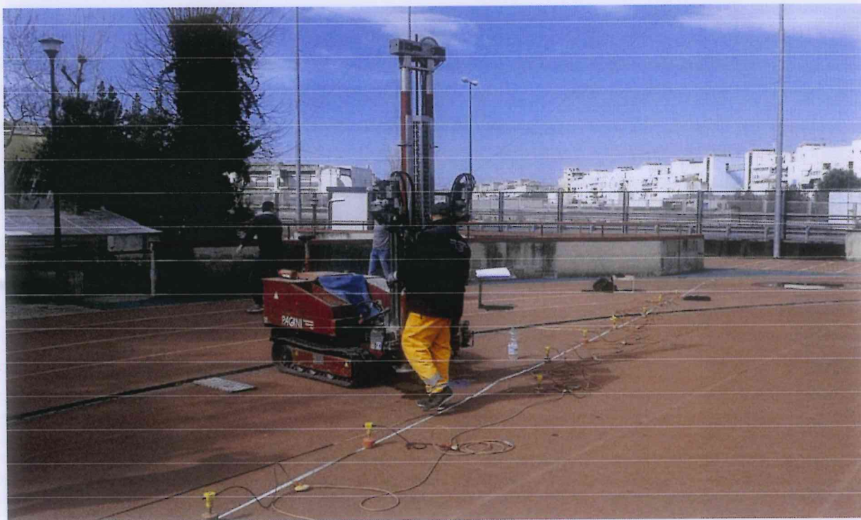
Penetrometro utilizzato per l'indagine geotecnica – Sondaggio P2
