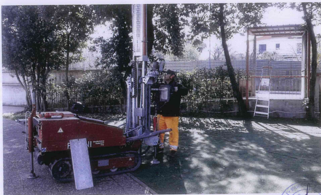
Penetrometro utilizzato per l'indagine geotecnica – Sondaggio P1
